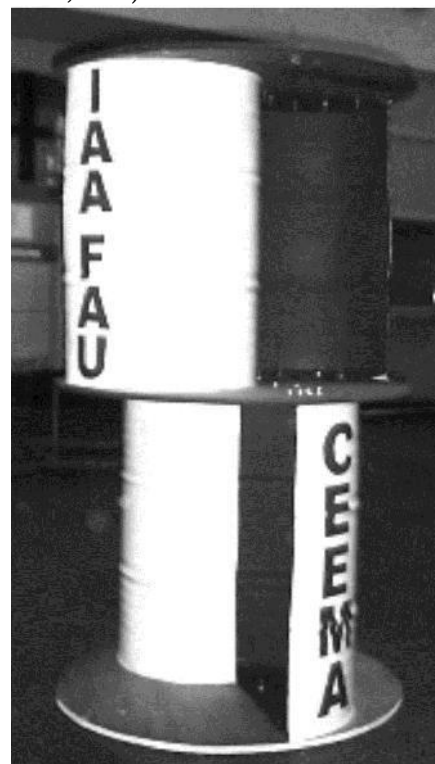
Fig. 4.37 Detalle de la turbina Savonius doble, construida en el IAA-FAU-UNT.
