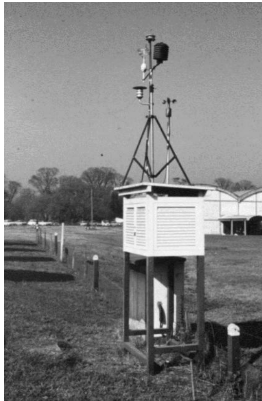
Fig.6.11 Casilla meteorológica normalizada y estación meteorológica remota, del IAA-FAU-UNT.
